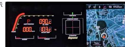
VEMメニューのアイコンから選択する以外には純正画面の状態からiDriveコントローラーのOPTIONボタンを長押しする事でも呼び出せます。
