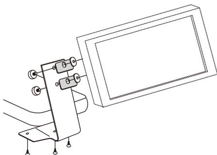
センターコンソールBOX蓋の裏側にモニタースタンドを付属ビスを使用して固定します。
