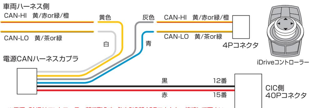
※電源、GNDはコントローラー部で取らず、必ずCIC部40Pコネクタへ接続して下さい。
